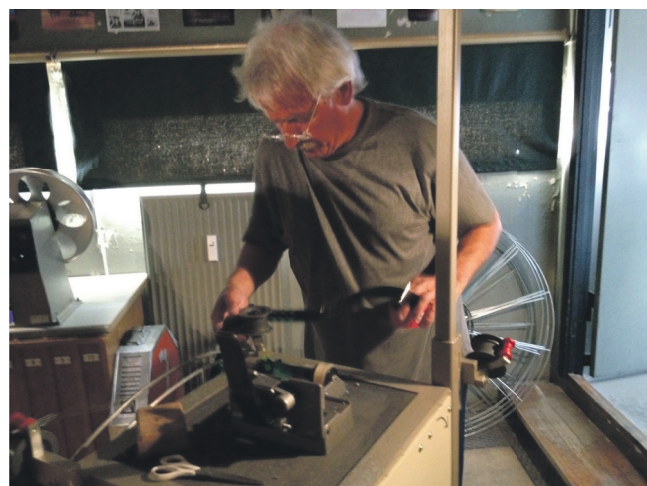
Til det analoge filmudstyr hørte selvfølgelig en plejsemaskine, så man hurtigt kunne gøre filmstrimlerne klar til aftenens forestilling. Bent Ærø var "chefoperatør" i Niels Kaisous tid og stod for klipningen af filmene. Foto: Lars Kensmark
